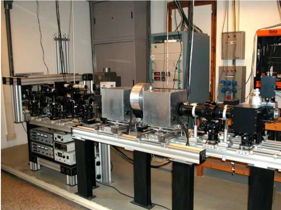
Abbildung 2.2: Seitenansicht von IBIS. In den silbernen Metallgehäusen befinden sich die FPIs. Das dazwischen befindliche runde Gehäuse enthält ein Filtrerrad mit Interferenzfiltern zur Wellenlängenselektion.
